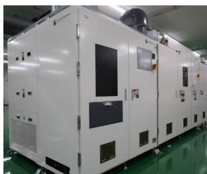
図2 開発した \beta -Ga 2 O 3 成膜向け6インチ枚葉式HVPE装置の外観写真
