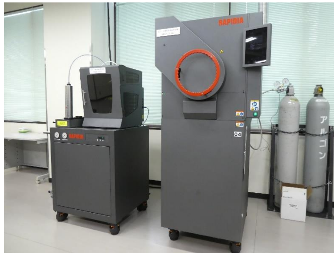
長野高専内ソーシャルイノベーション・サポートセンターに 設置された Rapidia 社製金属3Dプリンター
