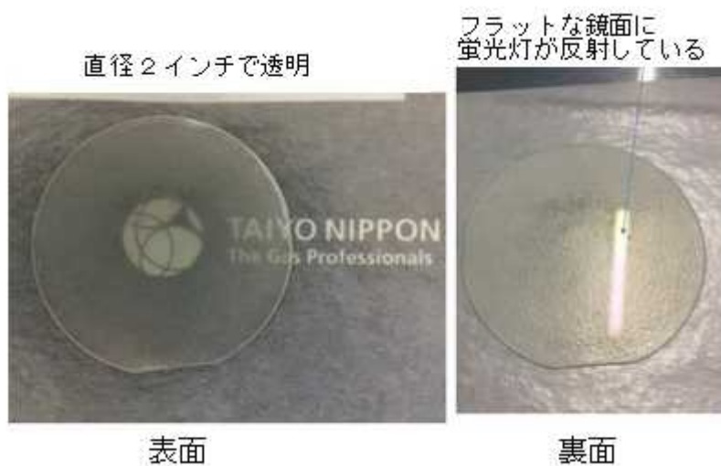
図5 直径2インチのGaN結晶例
