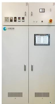
図2 高純度ヒドラジン供給システム外観
