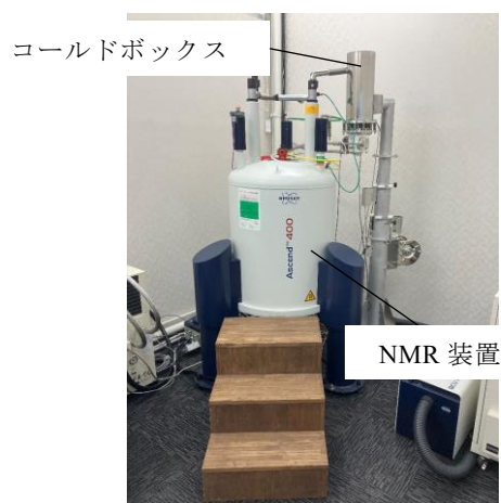
図 3 NMR 装置への設置状況
